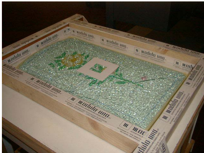
Fotografia 2: prova di frammentazione del vetro – campione 03.062.17281
