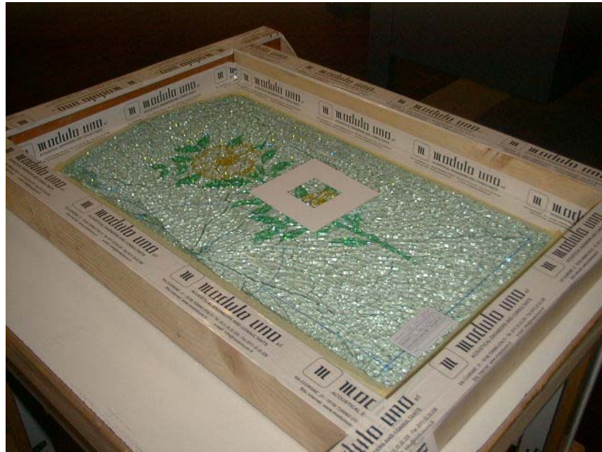
Fotografia 3: prova di frammentazione del vetro – campione 03.063.17281
